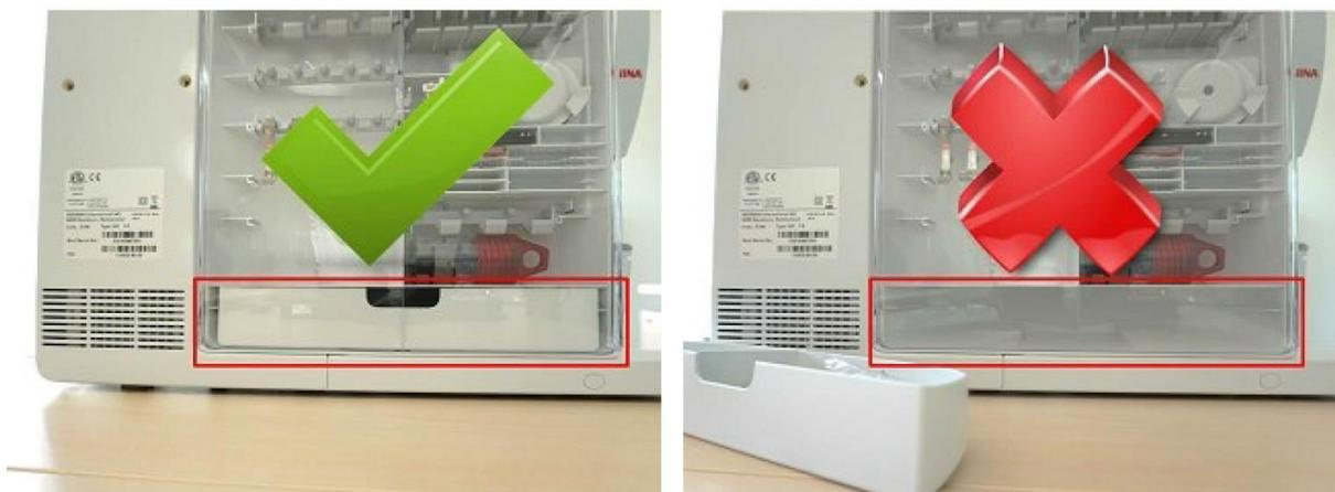
Stellen Sie sicher, dass die Schublade **IMMER** in der Zubehörbox korrekt eingesetzt ist, wenn die Zubehörbox zum Transport an die Maschine gesetzt wird.
