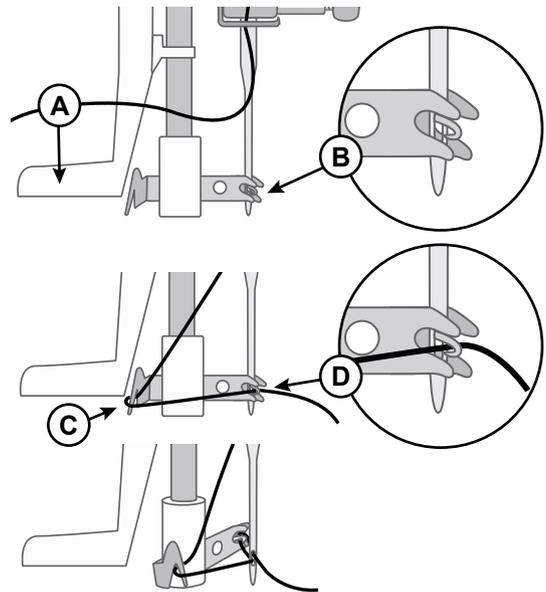
*Hinweis: Der Nadeleinfädler ist für Nadeln der Stärke 70–110 vorgesehen. Er kann nicht für Nadeln der Stärke 60 oder kleiner, Wingnadeln oder Zwillingnadeln verwendet werden. Das manuelle Einfädeln ist auch beim Einsatz mancher optionaler Zubehörteile notwendig. Zum manuellen Einfädeln ziehen Sie den Faden von vorn nach hinten durch das Nadelöhr.*
