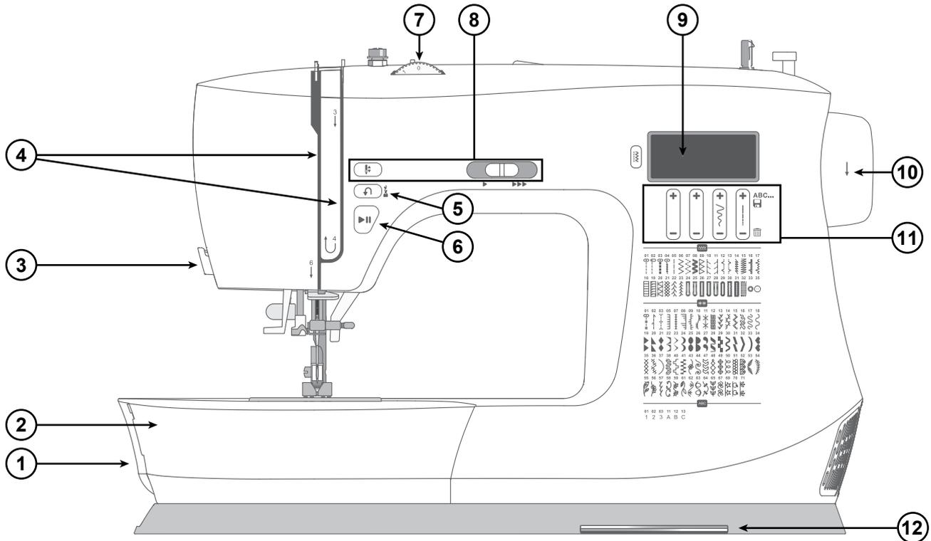
1. **Transporterheber** – durch seitliches Verschieben lässt sich der Transporter (de)aktivieren. Er befindet sich auf der Rückseite des Freiarms.
