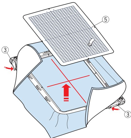
5 Ziehen Sie den Stoff in alle 4 Richtungen stramm um diesen zu spannen. Stellen Sie sicher, dass der Stoff straff eingespannt ist.
