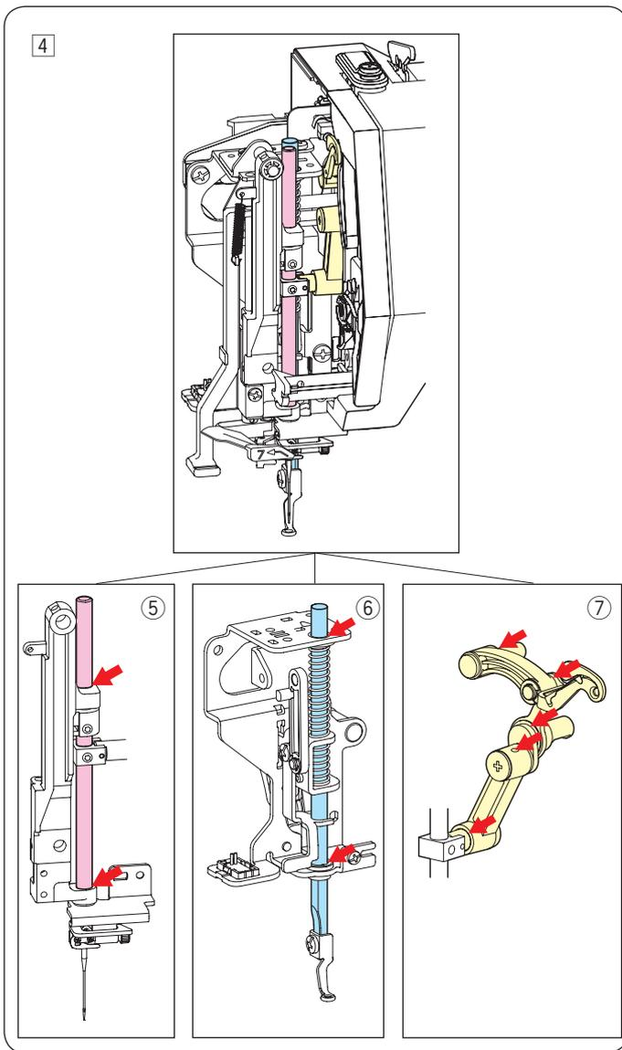
4 Ölen Sie die Pfeilpunkte wie in der Abbildung gekennzeichnet.
