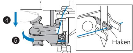
\* Vergewissern Sie sich, dass der Haken durch das Nadelöhr geht und fassen Sie den Faden.
