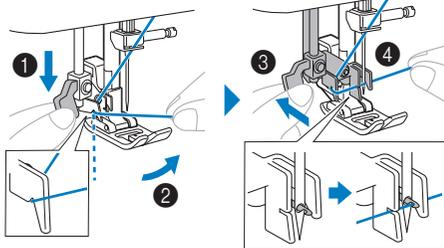
3 Bringen Sie den Nadeleinfädlerhebel langsam nach vorne und lassen Sie den Hebel dann langsam los.
