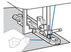
► Nach dem Nähen näht die Maschine automatisch Verstärkungsstiche und stoppt dann.
