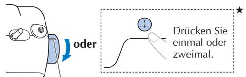
Drehen Sie zu Ihnen hin, so dass diese Markierung nach oben zur höchsten Position zeigt.
