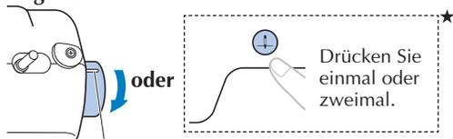
Drehen Sie zu Ihnen hin, so dass diese Markierung nach oben zur höchsten Position zeigt.
