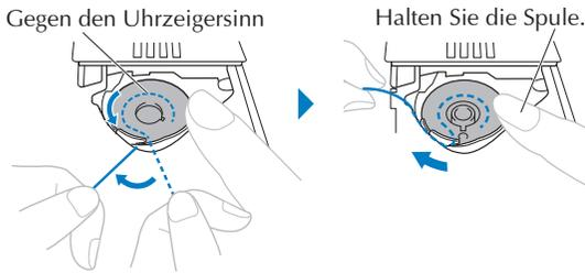
\* Befolgen Sie diese Anleitung, damit der Faden korrekt durch die Spannfeder der Spulenkapsel eingeführt wird.
