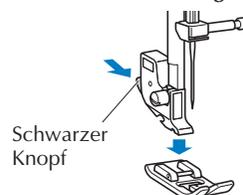
Ziehen Sie den Nähfuß vertikal nach unten.
