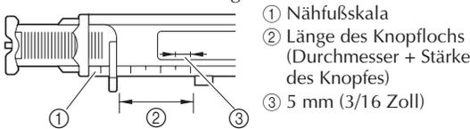
Beispiel: Für einen Knopf mit einem Durchmesser von 15 mm (9/16 Zoll) und einer Stärke von 10 mm (3/8 Zoll) wird die Knopfführungsplatte auf 25 mm (1 Zoll) auf der Skala eingestellt.
