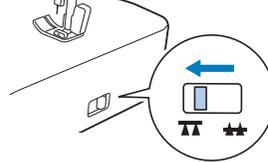
► Der untere Transporter wird abgesenkt.
