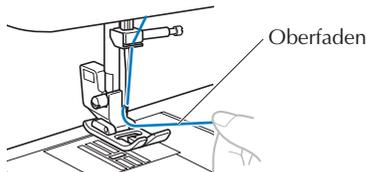
5 Halten Sie das Ende des Oberfadens fest, senken und heben Sie die Nadel an, um den Unterfaden hochzuziehen.
