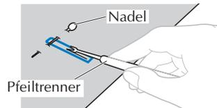
Verwenden Sie bei Augenknopflöchern die Ahle, um zuerst das Knopflochauge zu durchstechen, und schneiden Sie dann das Knopfloch mit dem Pfeiltrenner auf.
