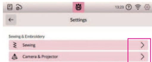
Für eine genaue Projektionsvorschau im Nähmodus lässt sich der Projektor kalibrieren. Eine Anleitung, für die Kalibrierung erhalten Sie über die Pfeiltasten die nach rechts zeigen.
