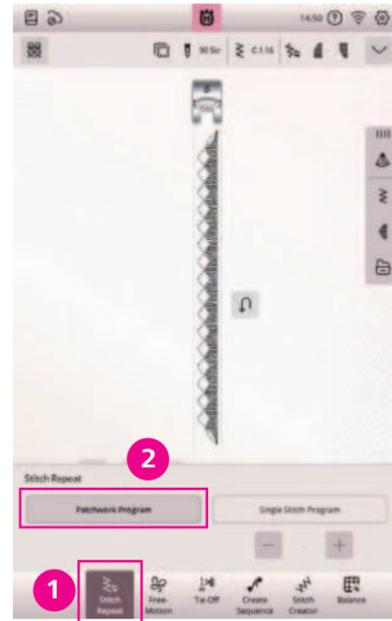
**Hinweis:** Über die Funktion **Creator Sequence/Stichfolge erstellen**, können Sie gleiche oder unterschiedliche Stiche aneinanderfügen. Die Länge für die entstandene Sequenz wird Ihnen im **Sequence Creator/Stichfolge erstellen** Ansichtsfenster angezeigt. Kombiniert mit der **Einzelstich-Programm Funktion**, können Sie benötigte Stichlängen einstellen.
