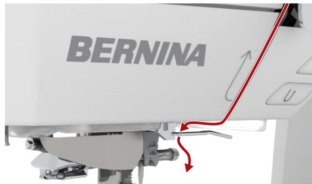
14. Faden von rechts nach links hinter die zweite Fadenführung im Nadelbereich führen.
