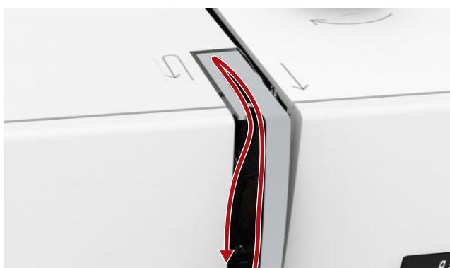
13. Faden von rechts nach links hinter die erste Fadenführung im Nadelbereich führen.
