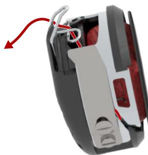
10. Zum Einsetzen der Spulenkapself, die Spulenkapself so halten, dass der Draht der Fadenführung nach oben zeigt.
