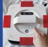
Drücken Sie die MODE-Taste, um in den Bechertransfermodus zu wechseln. Die Anzeige des Netzschalters wird orange. Wenn die Tassenpresse nicht angeschlossen ist, wird „000“ auf dem Bildschirm angezeigt.
