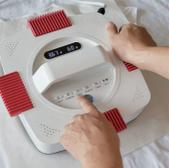
Setzen Sie die Presse auf die Teflonfolie und drücken Sie die TIMING-Taste, um den Timer zu starten.
