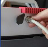
Verbinden Sie die Tassenpresse mit der Simple Press und drücken Sie die Ein-/Aus-Taste.
