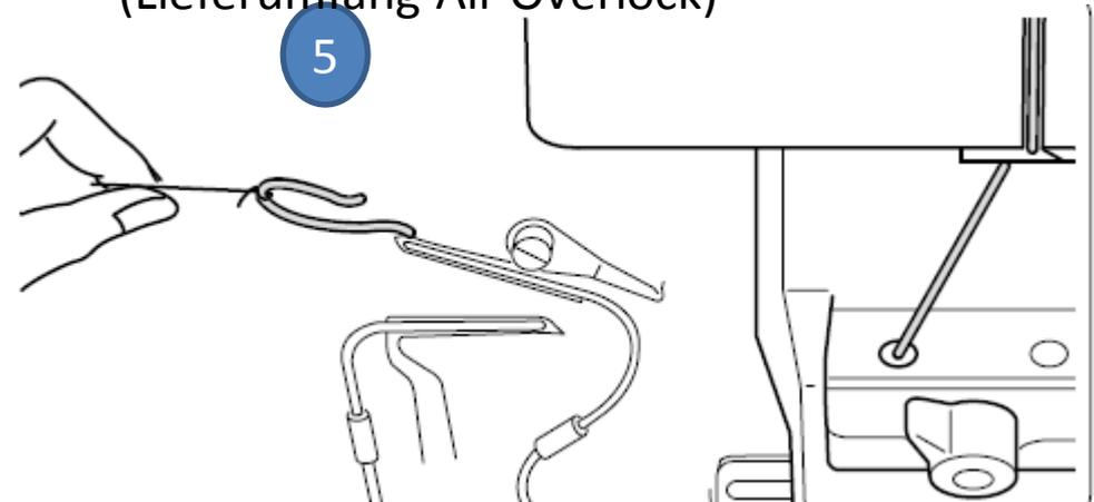
Methode 2: Der Anknüpfaden zum Einfädeln sollte ca. 30cm lang sein und um den Anfang des Spezialgarns gebunden werden. (1) Eingefädelt wird wie, wenn Sie reguläres Garn einfädeln(2/3). Der Anknüpfaden fädelt sich durch den Greiferweg und wird dann durch das jeweilige Greiferöhr mit dem Anknüpfaden gezogen.
