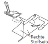
1. Stellen Sie den Differentialtransport auf 1 und drehen Sie den Arm heraus. Legen Sie den Stoff unter den Nähfuß und nähen Sie 2 oder 3 Stiche (ohne den Arm zwischen den Stoffen zu positionieren.)
