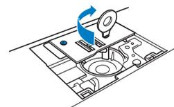
Prüfen Sie durch Drehen des Handrades, dass sich der Transporteur frei bewegt und die Schlitzkanten in der Stichplatte nicht berührt.
