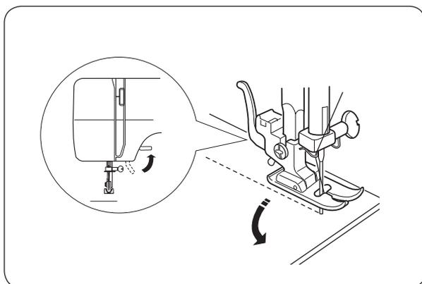
Maschine stoppen und das Handrad entgegen dem Uhrzeigersinn drehen, um die Nadel in den Stoff abzusenken.
