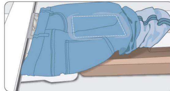
Bei schwierig einzuspannenden Projekten wie Jeans oder Hosen, krempeln Sie das Hosenbein hoch und führen das untere Hosenbeinteil über den Freiarm. Spannen Sie Stickvlies ein und bringen Sie den Stickrahmen an. Platzieren Sie die Hose auf den Stickrahmen. Ziehen Sie das Bein noch weiter auf den Freiarm. Platzieren Sie die Hose richtig. Stecken Sie sie an einigen Stellen fest. Nachdem Sie Ihr Stickmotiv ausgewählt haben, platzieren Sie es mithilfe der Projektion oder der Stickrahmen Scanfunktion.
