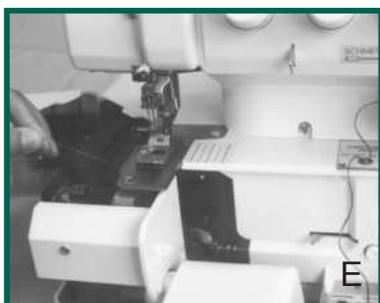
1. Öffnen Sie die vordere und seitliche Abdeckung und lüften den Nähfuß.
