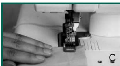
1. Legen Sie den Stoff so unter den Nähfuß, dass sich die Nadel (n) direkt über dem Stoff befinden ( Abb. A ).
