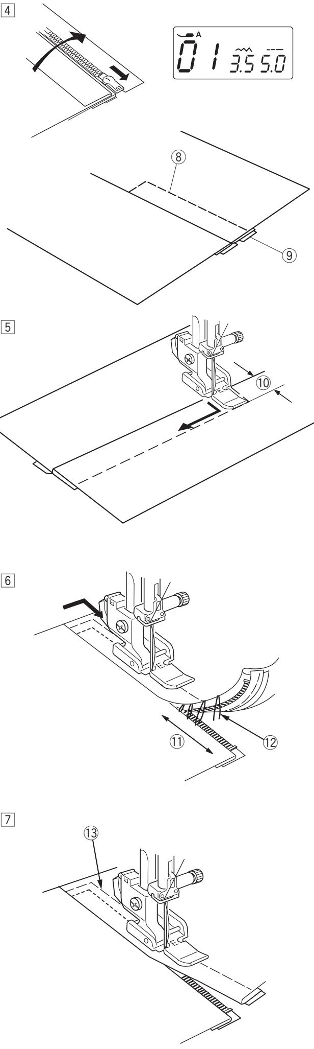
**4** Schließen Sie den Reißverschluss, und legen Sie den Stoff mit der rechten Seite nach oben flach über den Reißverschluss. Bringen Sie den Zick-Zack-Fuß A an. Stellen Sie die Stichlänge auf 5,0, die Stichbreite auf 3,5 (Standardwert) und die Fadenspannung auf 1. Heften Sie den Stoff und das Reißverschlussband zusammen.
