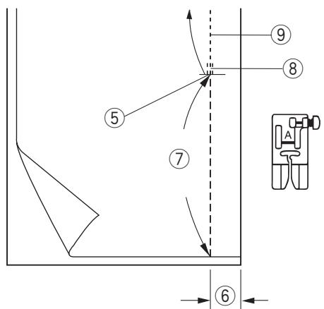
Legen Sie die rechten Seiten des Stoffes zusammen. Befestigen Sie den Zick-Zack-Fuß und nähen Sie mit einer Nahtzugabe von 2 cm bis zur Reißverschlussöffnung. Nähen Sie Rückwärtsstiche, um die Naht zu vernähen.
