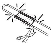
1 Gehen Sie genauso vor wie beim Nähen eines eckigen Knopfloches. Stellen Sie die Stichbreite je nach Stärke des verwendeten Einlauffadens ein. Stellen Sie den Knopflochfuß hoch und legen Sie den Einlauffaden über die Führung an der Rückseite des Knopflochfußes. Ziehen Sie beide Fadenenden unter dem Knopflochfuß in ihre Richtung, so dass sie unter dem vorderen Ende herausragen.
