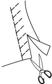
Verwenden Sie den Stoff so, dass eine Nahtzugabe von 1,5 cm übersteht. Schneiden Sie den überschüssigen Stoff nahe an der Naht ab. Vorsicht - schneiden Sie dabei nicht in die Naht.
