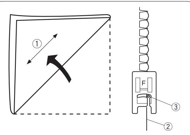
Benutzen Sie einen feinen Stoff (wie z.B. Trikot). Falten Sie den Stoff wie abgebildet diagonal, und nähen Sie über die Faltkante.
