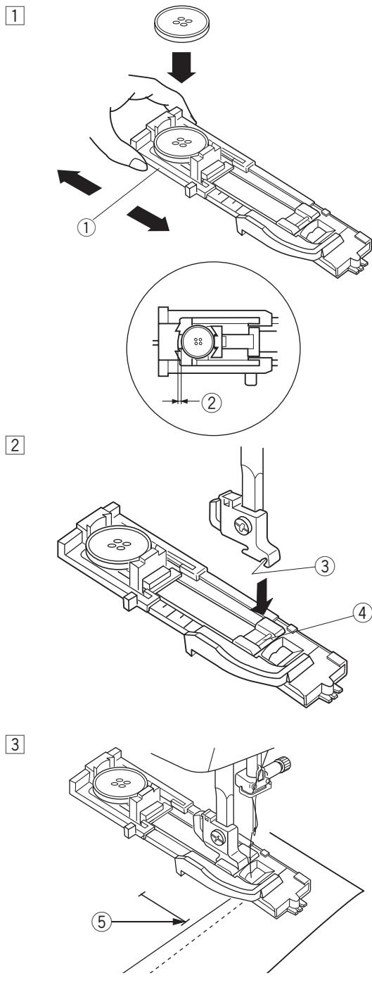
Die Größe des Knopflokches wird automatisch eingestellt, indem ein Knopf hinten in den Automatik-Knopflochfuß R gelegt wird.
