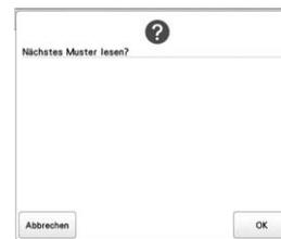
**14 Um ein anderes vom Computer übertragenes Muster zu öffnen, berühren Sie , und wiederholen Sie anschließend den Vorgang ab Schritt 10, um das Sticken fortzusetzen.**
