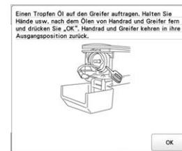
7 Setzen Sie nach dem Ölen die Spulenkapselfern in den Greifer ein, und schließen Sie die Greiferabdeckung. (Seite 35)
