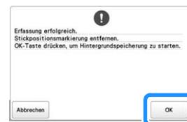
→ Der am Stoff befestigte Stickpositions-Aufkleber wird erkannt und danach der Stickrahmen bewegt.
