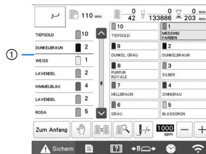
① ( ) gibt an, wann die Garnrollen gewechselt werden müssen. Die Garnrollen müssen so häufig gewechselt werden, wie diese Anzeige erscheint, und zwar an der Stelle zwischen den beiden Garnfarben, an der sie angezeigt wird.
