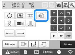
→ Es wird ein Bildschirm angezeigt, in dem Sie die Nadelstangennummern auswählen können.
