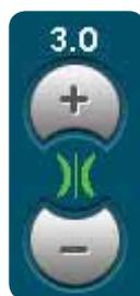
*Nachdem Sie den Wert im Einstellungsmenü erhöht oder reduziert haben, wird das Steuersymbol für die Fadenspannung grün dargestellt.*
