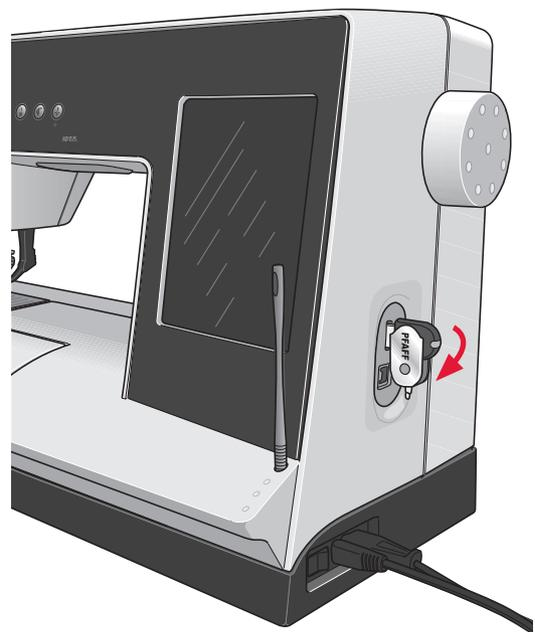
*Hinweis: Der im Lieferumfang Ihrer Näh- und Stickmaschine enthaltene USB Embroidery Stick kann in der Maschine verbleiben, wenn Sie die Kofferhaube aufsetzen. Achten Sie darauf, dass die Abdeckung des USB-Sticks nach unten weist.*
