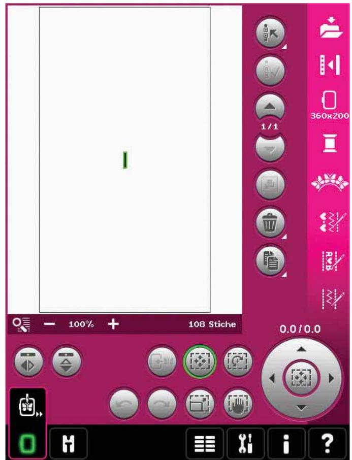
2. Öffnen Sie die Grundfunktion Shape Creator™. Wählen Sie aus der Liste die gerade Linie (A). Wählen Sie „Berührungsfunktion – Drehen“ und tippen Sie dann einmal auf das Rädchen-Mittelsymbol, um die Grundlinie um 90° zu drehen.
