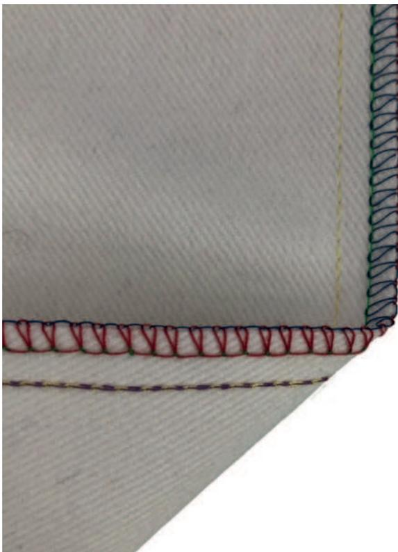
Dieser Stich ist eine Kombination aus einem 3-Faden-Overlockstich plus einem Kettenstich. Dieses Muster wird mit einer schmalen Overlockkante versehen. Verwende die linke Nadel für eine breitere Overlocknaht. Bei der b68 kann unter Verwendung der linken Coverstichnadel eine breitere Nahtzugabe erzielt werden.
