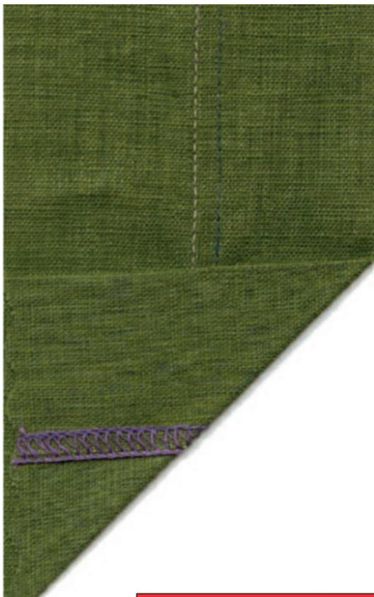
1. Richte die Overlocker für einen breiten 3-Faden-Coverstich unter Verwendung der linken Coverstichnadel und der rechten Coverstichnadel ein (entferne die mittlere Coverstichnadel und den Faden). Nimm die Einstellungen wie unten angegeben vor.
