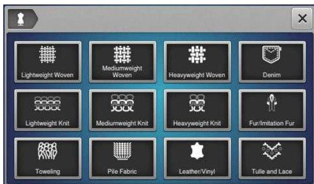
Mit der Funktion **Berater** können Sie für verschiedene Näh-, Stick- und Quilttechniken Empfehlungen zur Vorbereitung und Einstellung der Maschine erhalten. In Abhängigkeit von der gewählten Technik und des Stoffs werden unterschiedliche Empfehlungen angezeigt.
