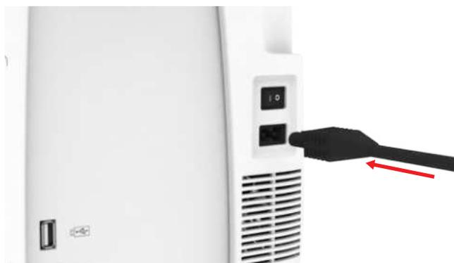
2. Den Netzstecker des Netzkabels in die Steckdose einstecken.
